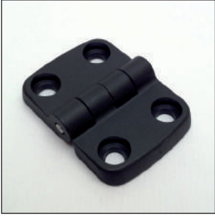
PA: Takviyeli Poliamid. Paslanmaz-çelik pim. Maks. dönüş: 270°
